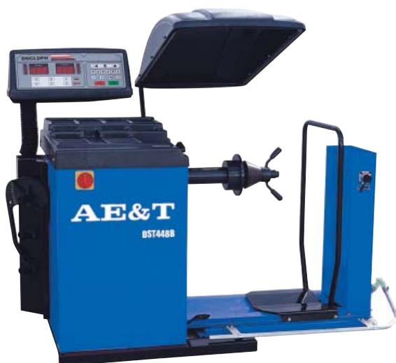
Универсальный балансировочный станок с пневматическим подъемным устройством для балансировки колес весом до 135 кг. Предназначен для обслуживания грузового транспорта.
